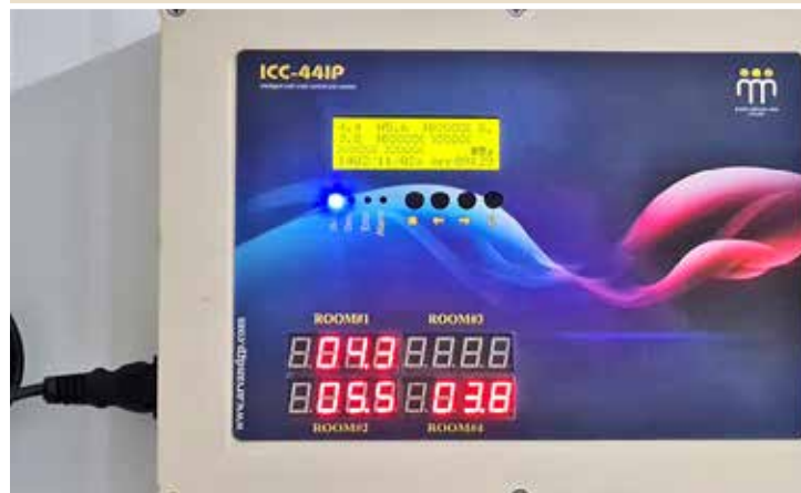
دستگاه هشدار دهنده تغییرات دمایی زنجیره سرما
